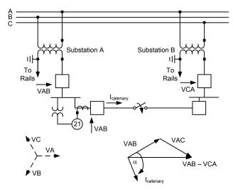
Fig. 21. Wrong Phase Coupling
