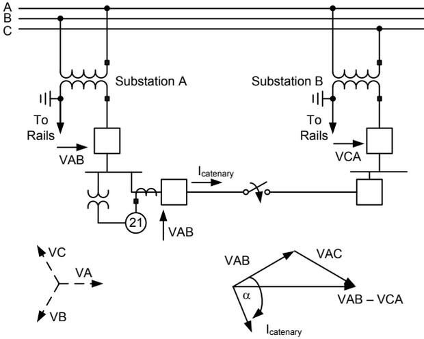
Fig. 21. Wrong Phase Coupling
