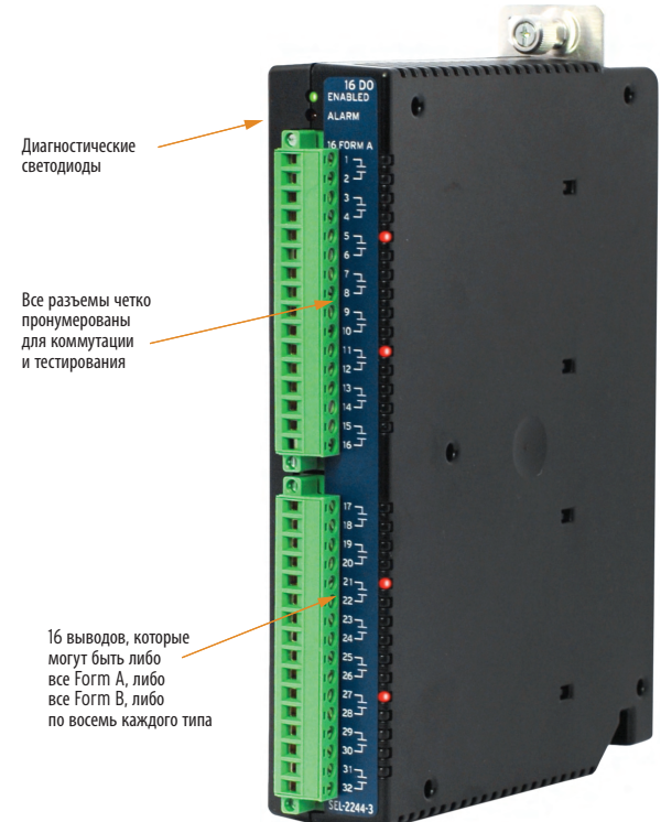
Рисунок 29 Модуль стандартного токового цифрового вывода SEL-2244-3, вид оконечной стороны
