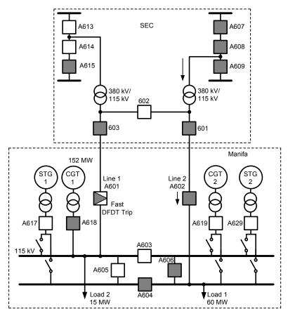
Fig. 14. Fast DFDT In-Service Operation
