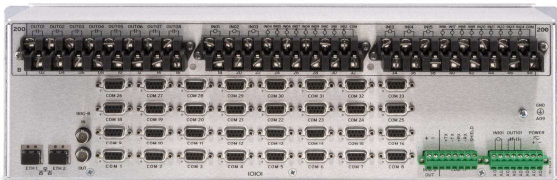
Figura 1 Tarjeta de Entradas/Salidas digitales en el SEL-3530
