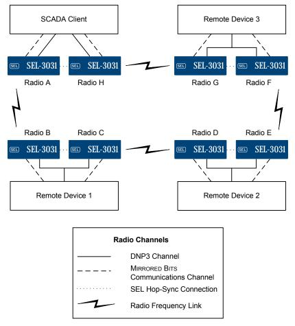
Figure 1 SEL-3031 Hop-Sync Ring Example Diagram
