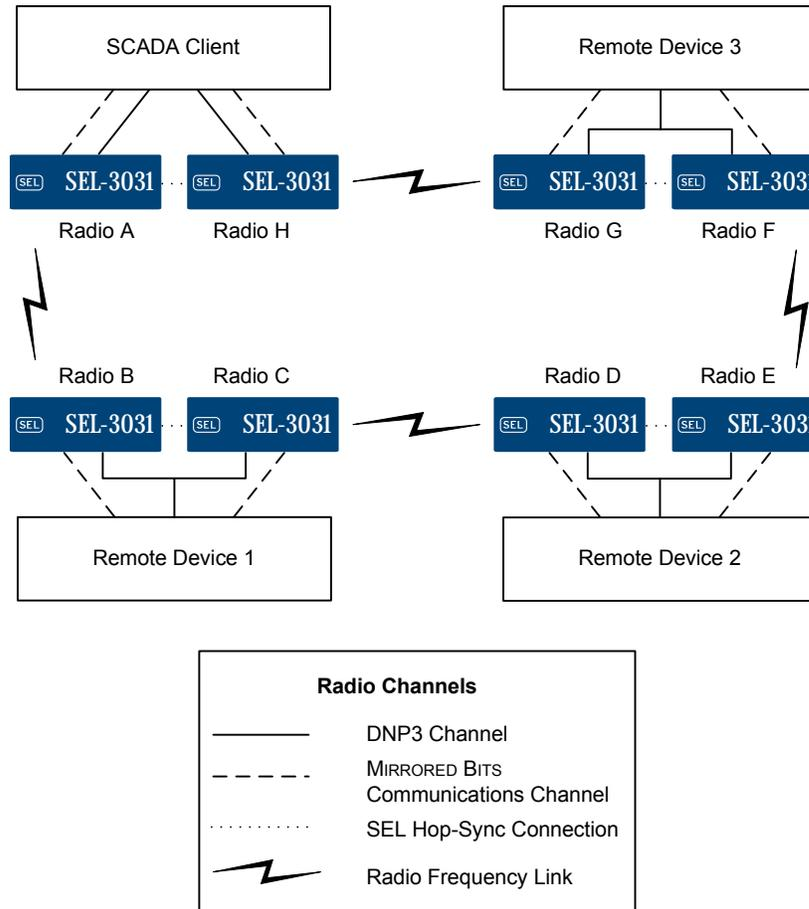
**Figure 1 SEL-3031 Hop-Sync Ring Example Diagram**
