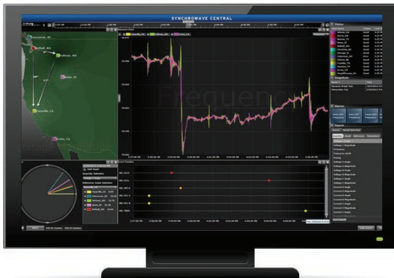
Мониторинг состояния энергосети с помощью синхронизированных по времени сообщений синхрофазоров.
