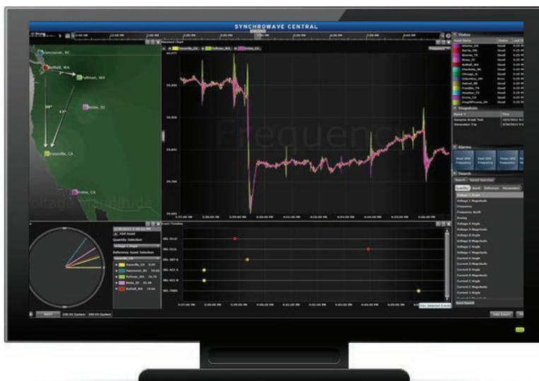
Surveillance de l'état du réseau électrique grâce aux messages synchronisés de synchrophaseur
