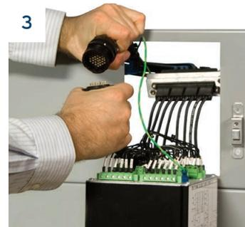
3 Retire las desconexiones rápidas.
