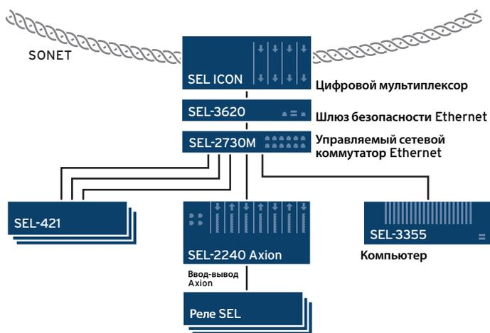
В этом примере сети подстанции SEL-2730M поддерживает порты для служебного доступа, SCADA, синхрофазоры и многие другие функции в удобной конфигурации.
